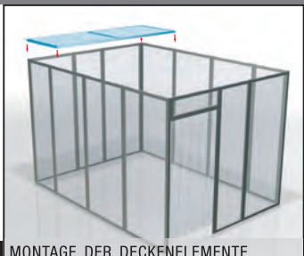
7 MONTAGE DER DECKENELEMENTE
